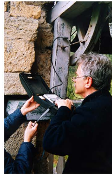
L'ingegner Del Senno durante il rilievo dell'umidità presente nel rovere.
