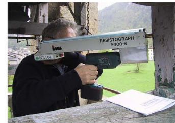
Una fase del rilievo stratigrafico effettuato penetrando direttamente nel legno per sondarne la resistenza.
