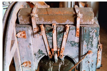
In alto: un particolare di uno dei ceppi smontati e portati in laboratorio. All'usura della ferramenta si accompagnava la presenza di muffe e d'insetti xilofagi (parassiti del legno) che avevano parzialmente intaccato il rovere.
