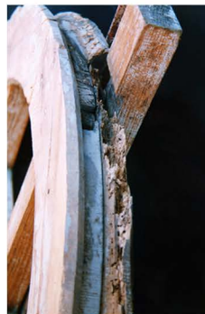
In alto: un particolare di uno dei ceppi smontati e portati in laboratorio. All'usura della ferramenta si accompagnava la presenza di muffe e d'insetti xilofagi (parassiti del legno) che avevano parzialmente intaccato il rovere.
